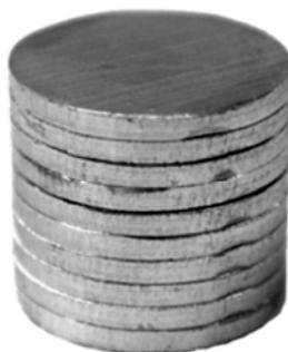
Рис. 1. «Сторпка» для испытания на сжатие
